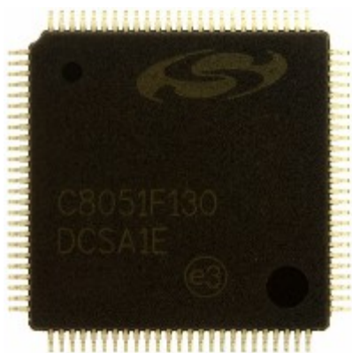
Współczesny klon rdzenia 8051 produkcji firmy Silicon Laboratories, jego cena to ok. 15$
